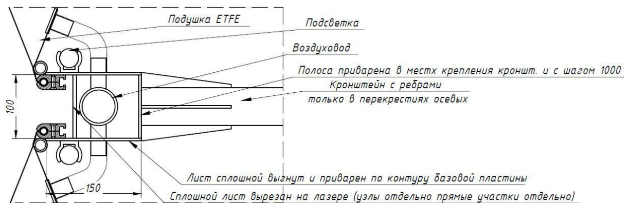
Узел типовой ЭТФЭ-подушка 2 слоя, утепление
